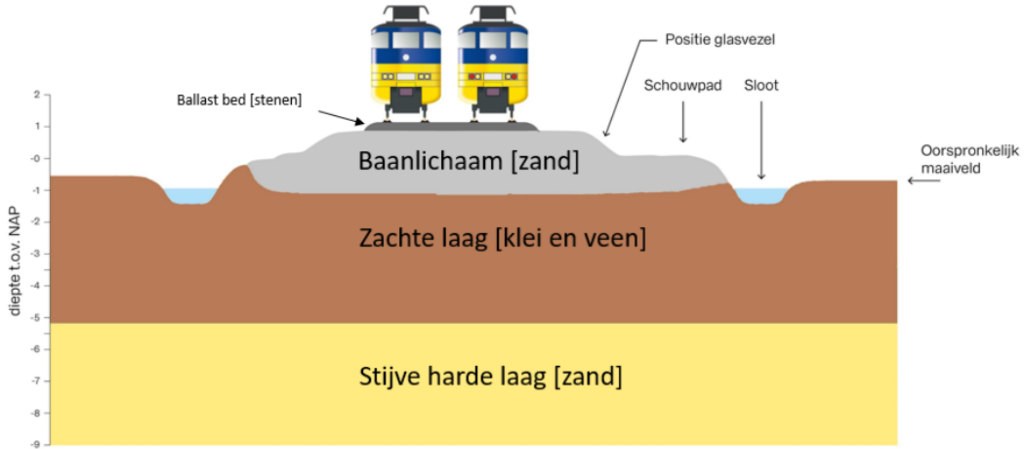
Figuur 1 Overzicht van de positie van de glasvezel, het schouwpad, het ballast bed, baanlichaam, de zachte laag en de stijve harde laag voor een deel van het onderzoekgebied.
