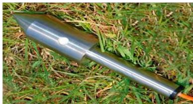
Figuur A.29 Waterspanningsmeter van het type GeoBeads (Alert Solution)
