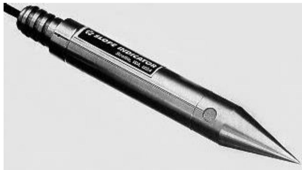
Figuur A.27 Voorbeeld van een vibrating wire waterspanningsmeter
