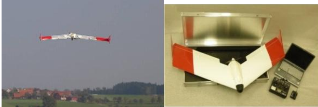
Figuur A.22 GeoHawk in actie (links) met controle-laptop en bediening) [bron: http://www.vb-ecoflight.nl ]
