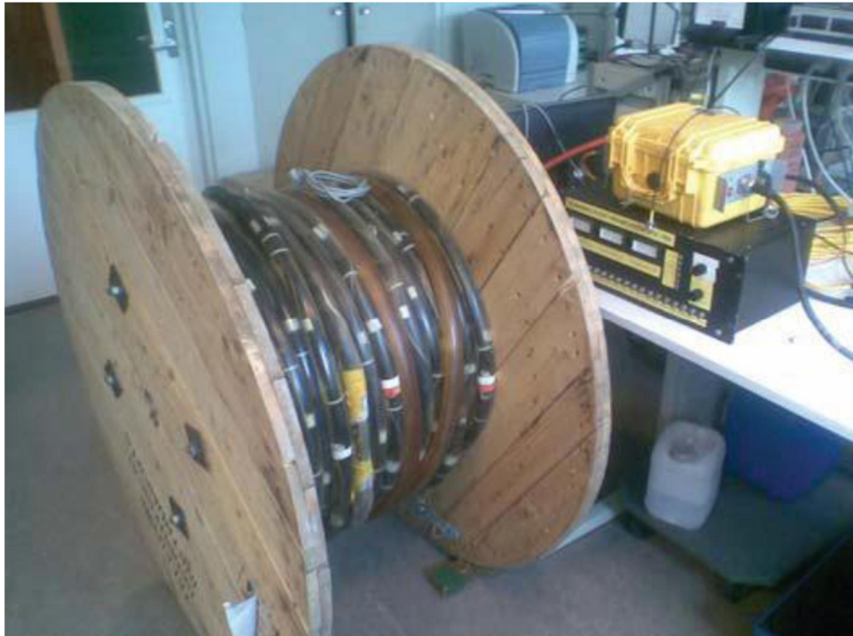
Figuur A.34 Array met hydrofoons gewikkeld op een klos [STOWA, 2010b]
