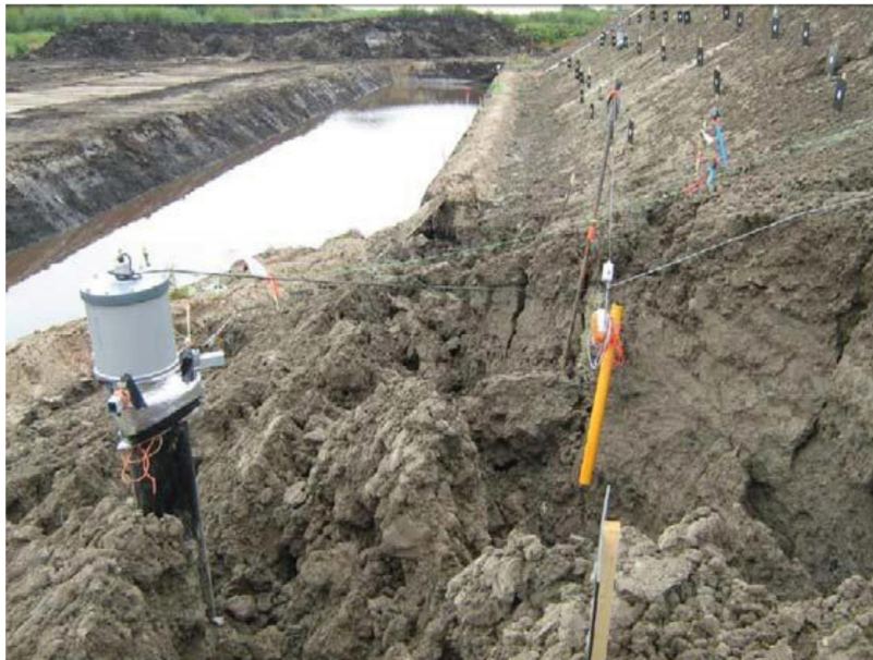
Figuur A.11 Een inverted pendulum bij de IJkdijk [STOWA, 2006]
