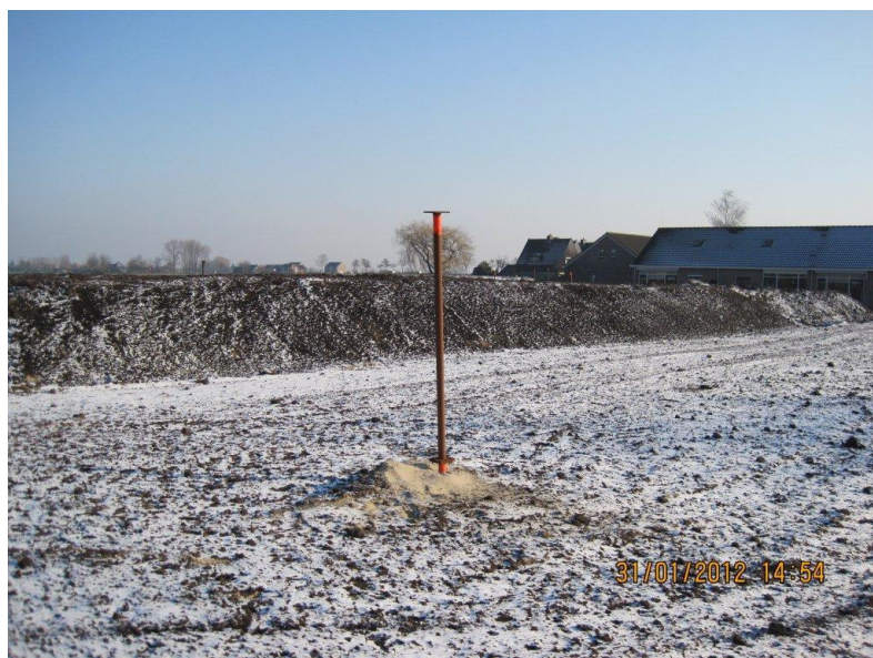
Figuur A.2 Mechanische zakbaak [bron: www.zakbaken.com ]
