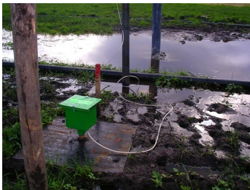
Figuur A.3 Elektronische zakbaak [bron: www.bannelisderuiter.com ]
