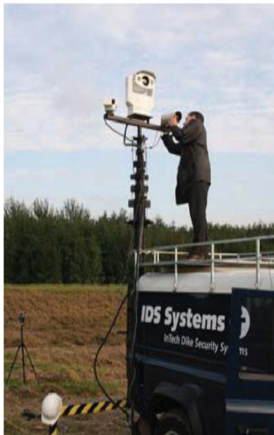
Figuur A.23 Infrarood camera van Intech Dike Security systems, gebruikt bij de IJkdijk [STOWA, 2010b]
