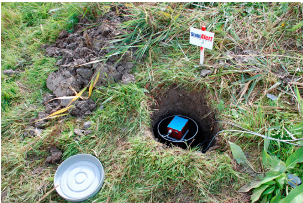
Figuur 13 Meetsysteem zoals aangebracht in de dijkhelling
