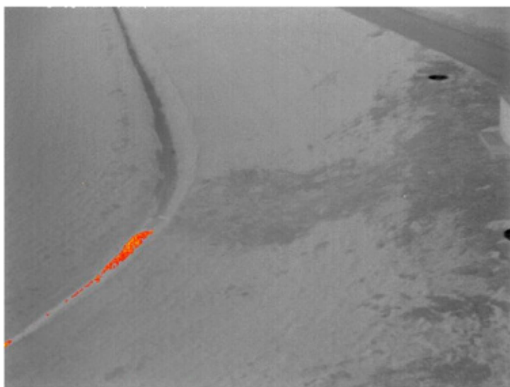
Figuur 2.5 Voorbeeld IR meting ter plaatse van DMC
