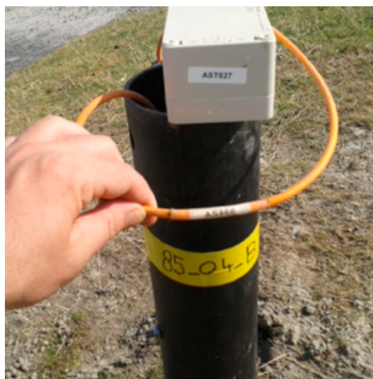
Figuur 3.5 Installatie waterspanningsmeters: diepe plaatsing met mini boorrups en plaatsing van schutkokers met Modem-Loggers
