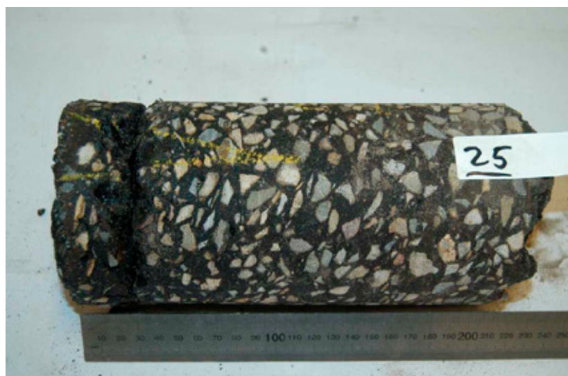
Figuur 3.11 Asfalt boorkern
