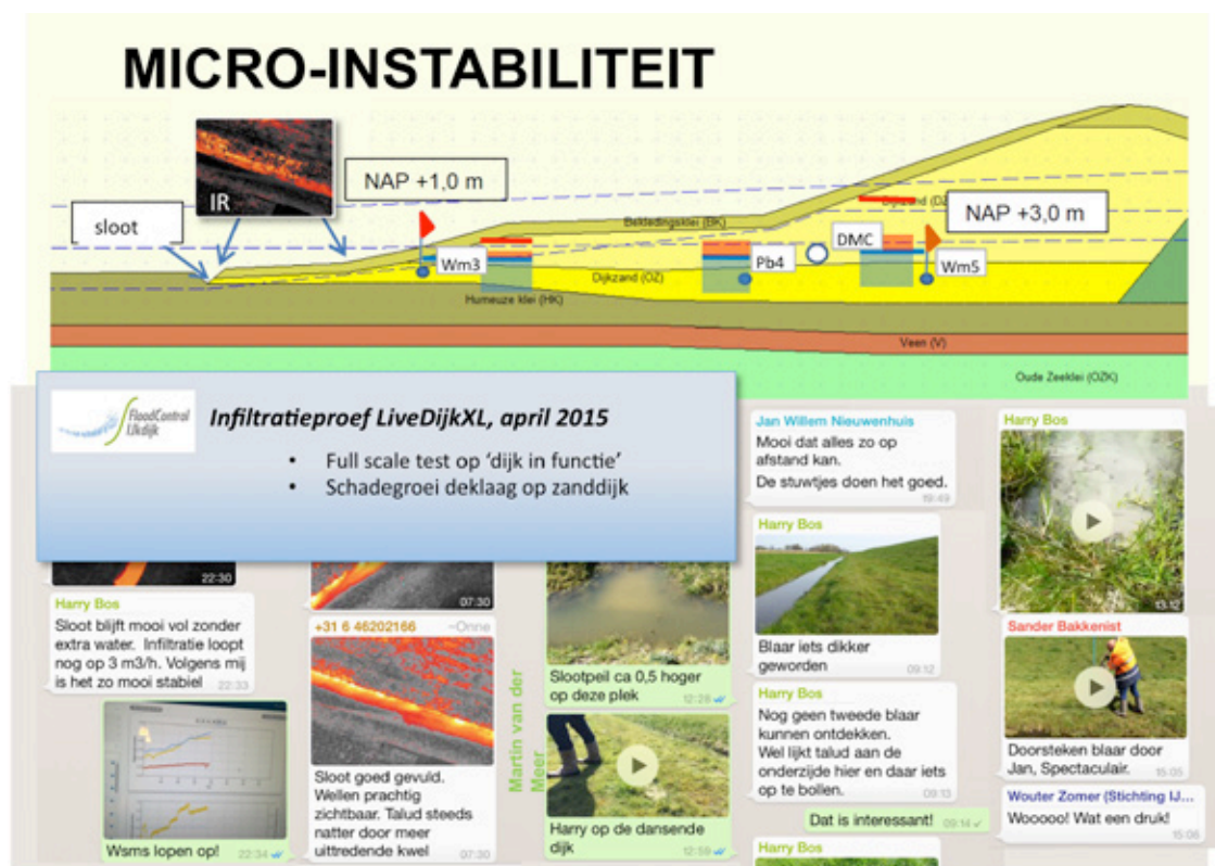
Figuur 2.12B Infiltratieproef XL OZD – te onderzoeken fenomenen
