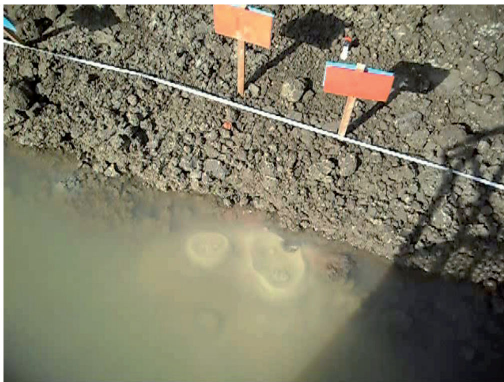
Figuur 4.4 Twee actieve zandkraters vlak bij elkaar. Merk op dat er in de rechterkrater twee afzonderlijke wellen zichtbaar zijn
