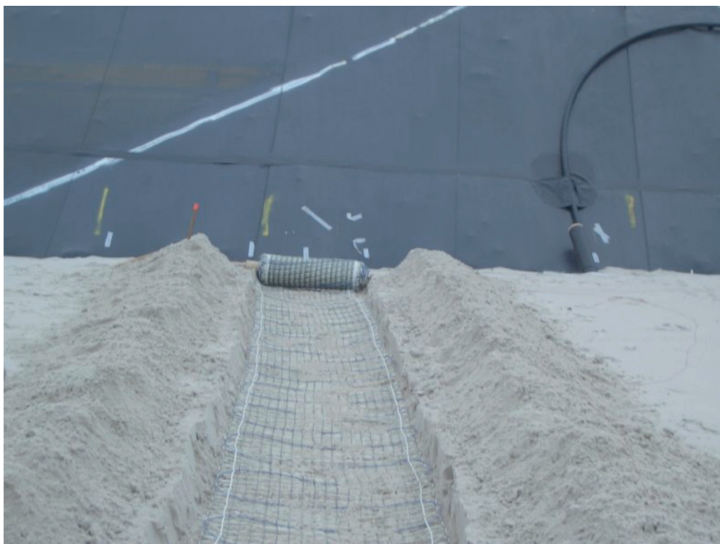
Figuur 5.4.8 Experiment 4 - fiberoptische -mat in zand
