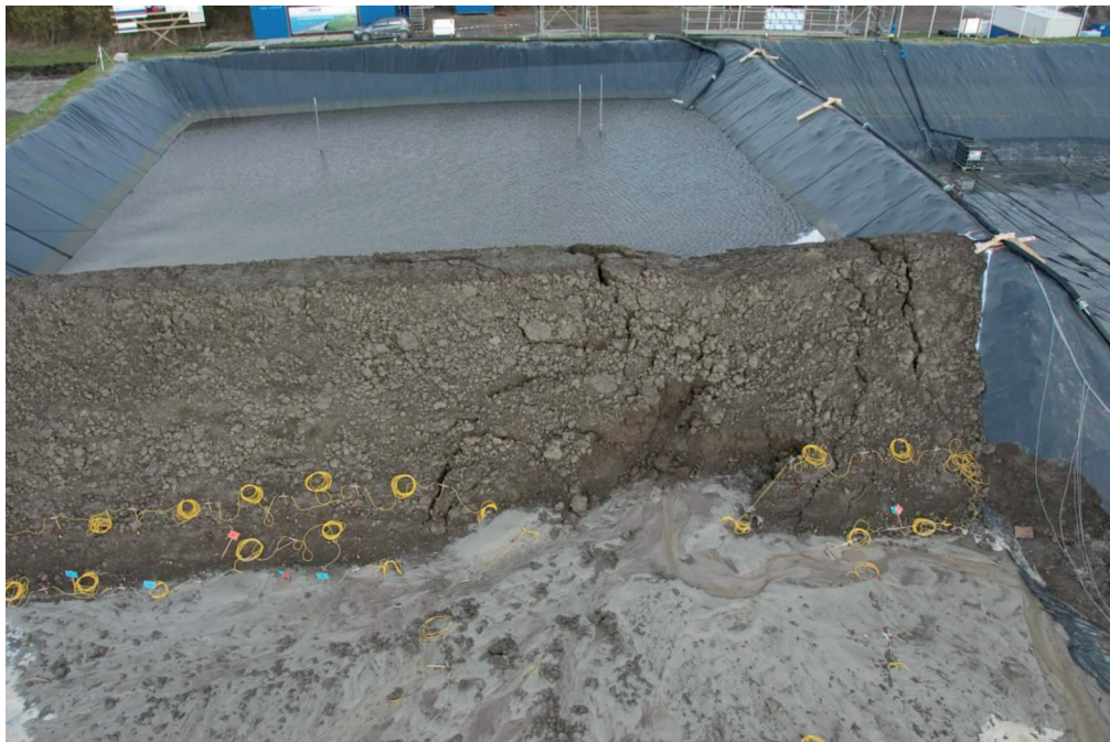
Figuur 4.10 Experiment 2 na bezwijken
