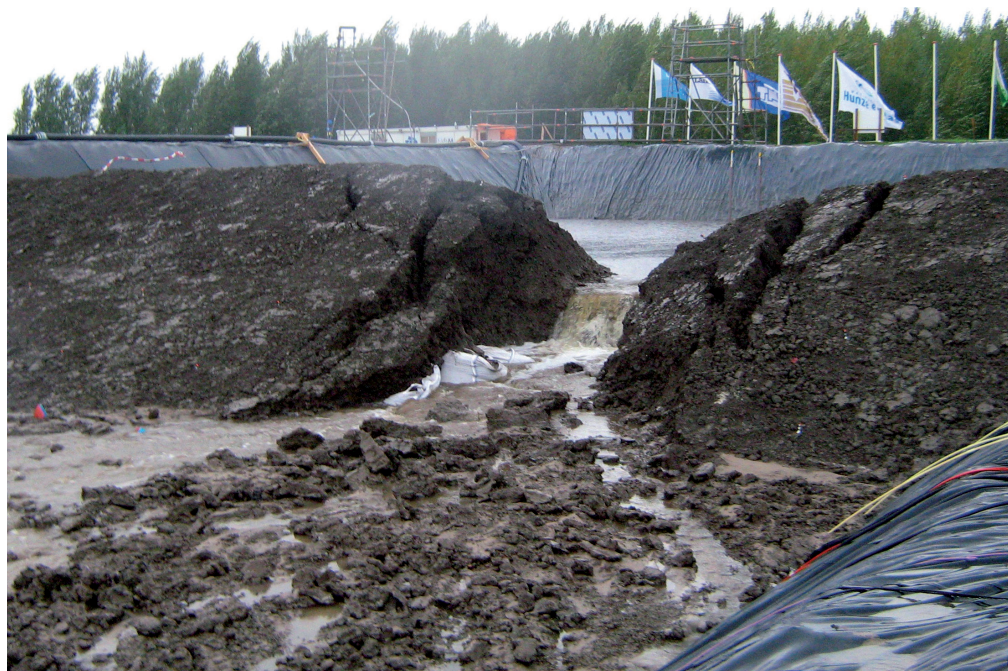
Figuur 4.8 Experiment 1 na bezwijken
