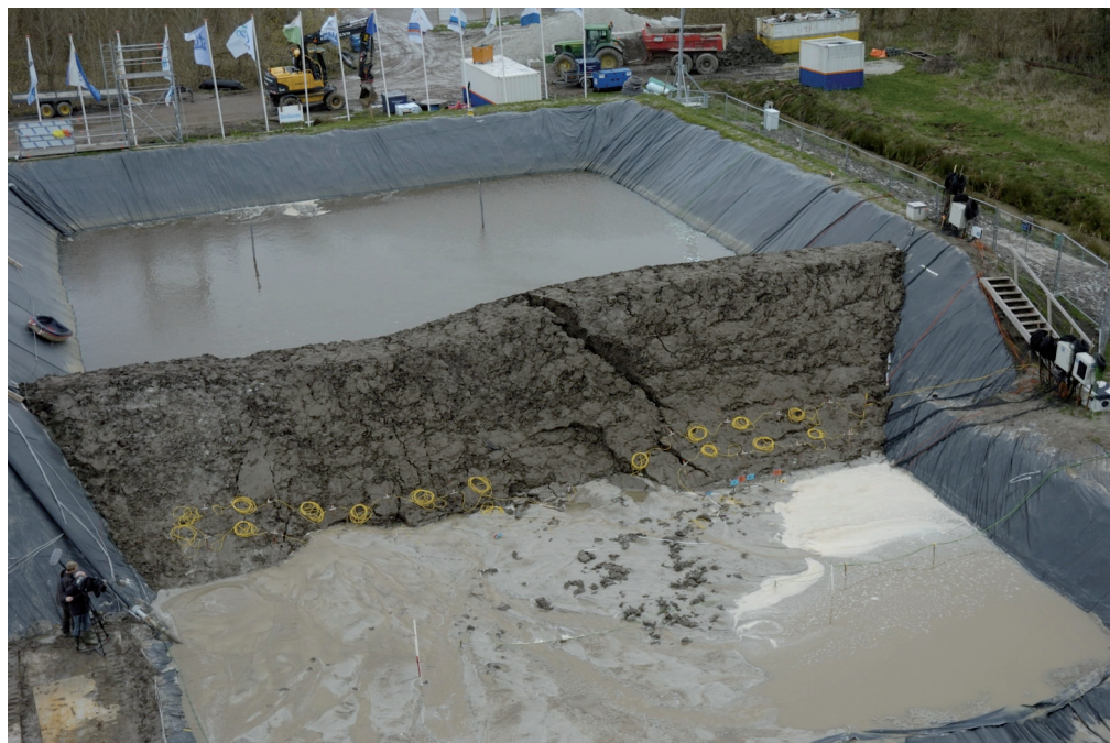
Figuur 4.12 Experiment 3 aan het einde van de bezwijkfase
