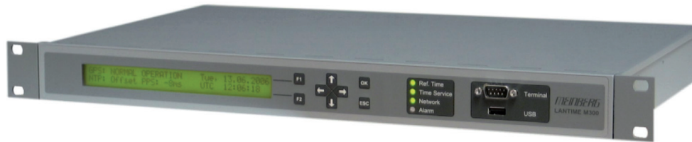
Figuur 3.18 NTP-Server aangesloten op GPS-buitenantenne voor accurate tijdsbepaling
