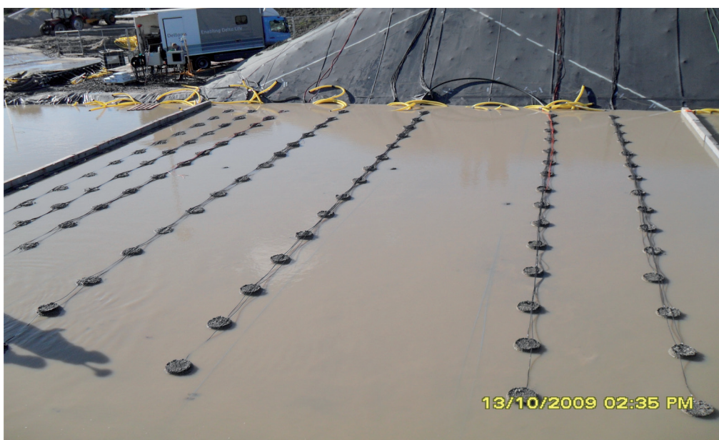
Figuur 5.10.3 Raaien waterspanningsmeters voor experiment 2, ingepakt in kleibroodjes gelegd op het geprepareerde zandbed (onder water)
