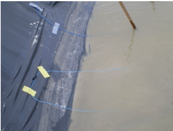
Figuur 5.8.3 Pipingexperiment 1: Lay-out van de optische kabel (blauw) aan een uiteinde van de dijk (d.w.z. aan een zijkant van het bassin)
