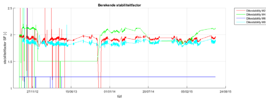
Figuur 3.1 Berekende stabiliteitsfactoren Voorhavendijk
