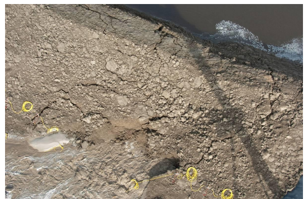
Figuur 3.18 Doorbraak proef 2 (toename zandtransport links en dijkdoorbraak rechts)
