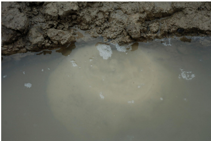
Figuur 3.5 Zandmeevoerende wel in proef 3 (T=71 uur)
