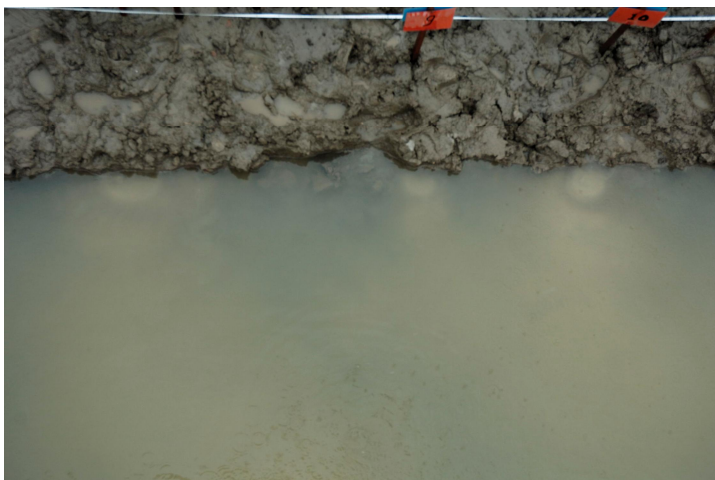
Figuur 3.6 Zandmeevoerende wellen in proef 3 (T=94 uur)
