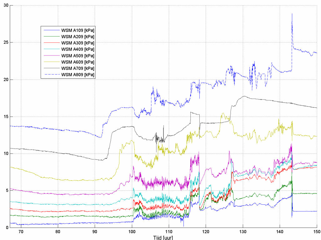
Figuur 3.16 Waterspanningen proef 2 nabij de uiteindelijke doorbraaklocatie
