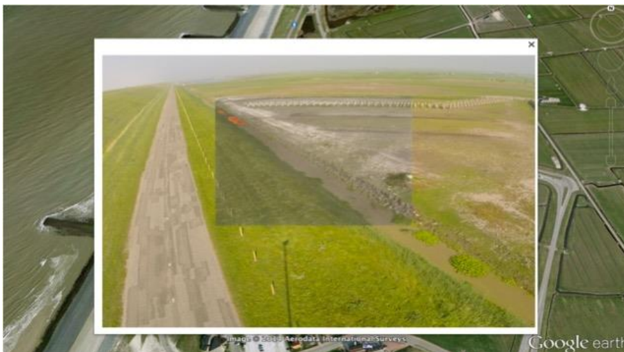
Figuur 5.2 Infrarood camera detectie van uittredend kwelwater, infrarood foto is over visuele foto geplaatst. Rode vlek geeft (significant) temperatuurverschil aan in slootwater – indicatie van uittredend kwelwater
