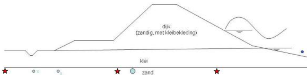
Figuur 5.2 Instrumentatie per dwarsdoorsnede voor meetdoel 1 bij piping (rode sterren: waterspanningsmeters, kleine cirkels: glasvezelsensoren, grote cirkel: DMC).
